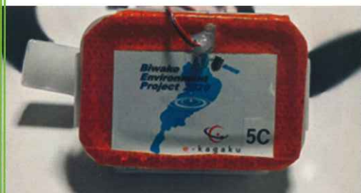
小・中学生が作った GPS 搭載の 環境測定ロボットロガー
